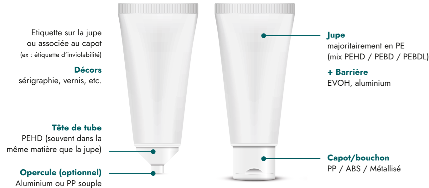
Figure 8 : Description d'un tube standard majoritairement en PE
